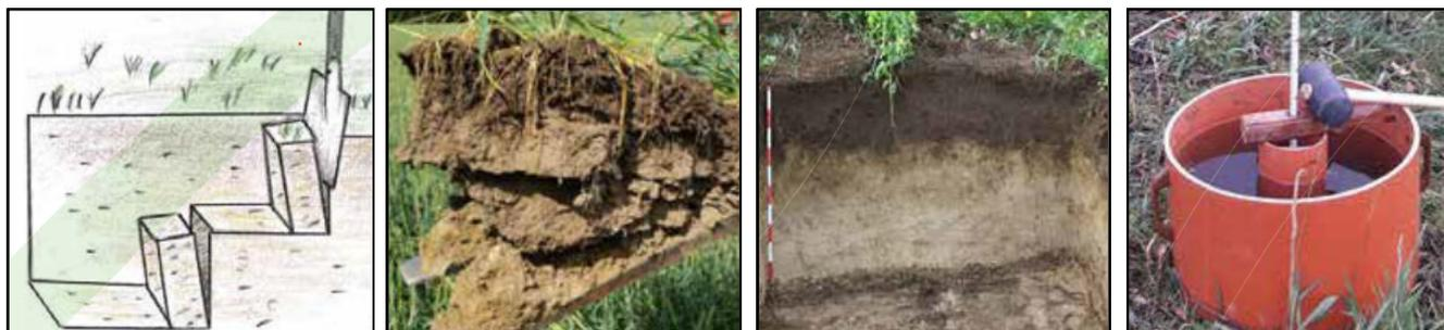
Von links nach rechts: Spatendiagnose, Profilgrube und Doppelringinfiltrrometer (INGUS).
