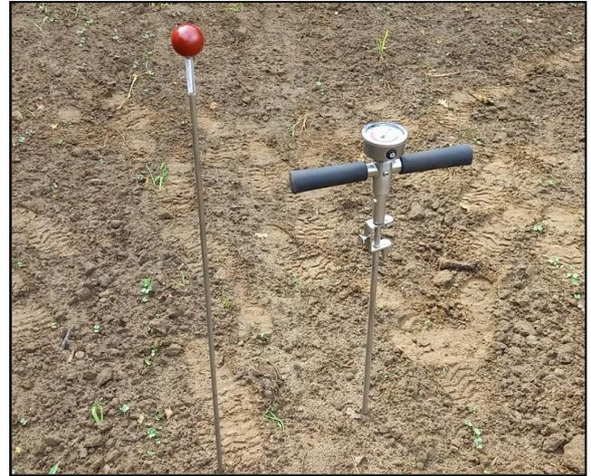
**Bodensonde und Penetrometer zum Erkennen von Bodenschadverdichtungen** (Foto INGUS)
